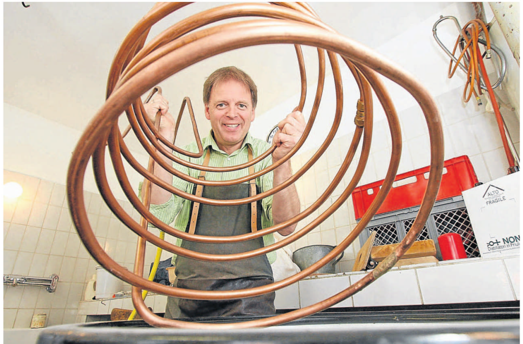
Die Gerätschaft fürs Bierbrauen ist primitiv: Thomas Köster hat ein Heizungsrohr aus Kupfer zur Kühltspirale umfunktioniert.
